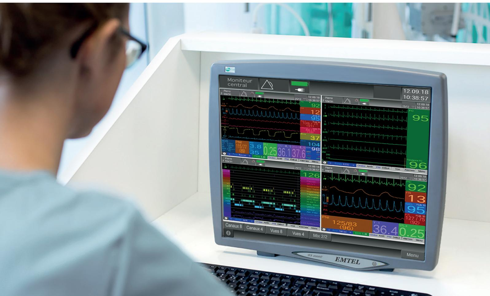
**Système de surveillance central qui rassemble les informations de tous les moniteurs connectés au réseau ensemble avec FX 3000C.**
